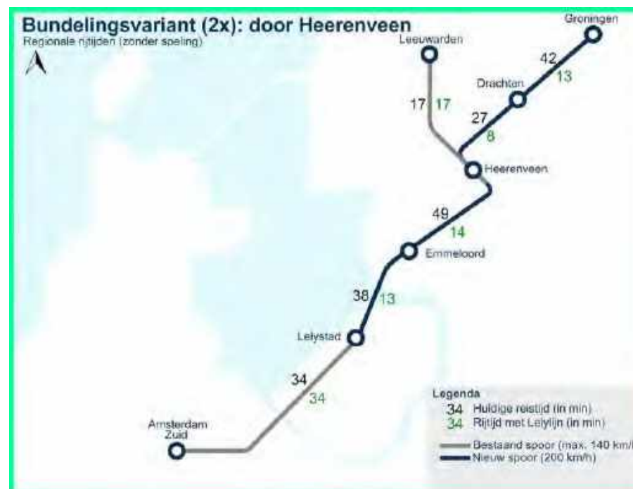
Figuur 16. Regionale rijtijden van de 2x-p/u-variant tussen Leeuwarden/Groningen en Amsterdam met stops in Heerenveen, Drachten, Emmeloord, Lelystad en Almere.
